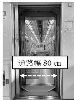
車両連結部通路
