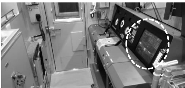
運転室の車両情報装置の表示パネル
