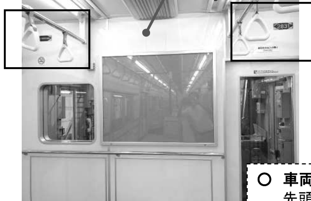
客室と運転室の仕切壁（先頭車両）
