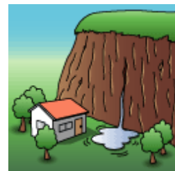
斜面やがけから水が急に噴出したとき
